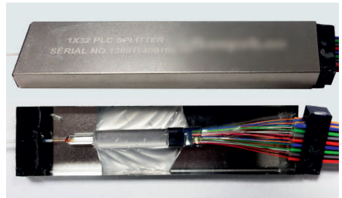
RYSUNEK 4 – Splitter 1x32 firmy Xyyyy, model oszczędnościowy (z małą ilością kleju) po badaniu w komorze
