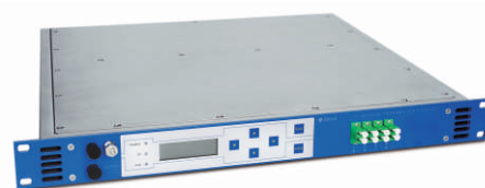
Niepozorna bestia – BKtel AOT16200, czyli nadajnik 1550 nm i EDFA 16x20 dBm w obudowie 1U
